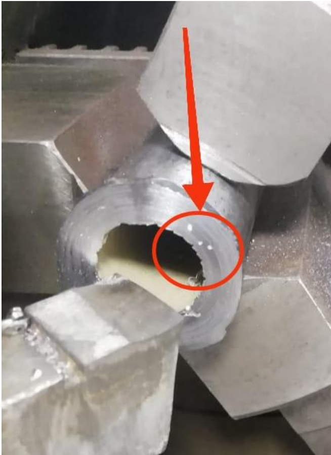
Рисунок 1.9. – Выборка на станке. Хордовая схема сканирования. Сетка пор в сечении шва. Объемный дефект
