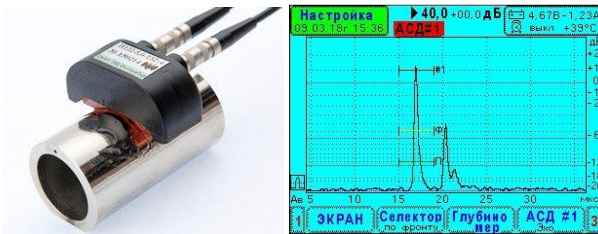
Рисунок 1.1. – Хордовая схема сканирования. Настройка на стандартный образец предприятия с плоскодонным отражателем. Пример длительности развертки при настройке на хордовый преобразователь
