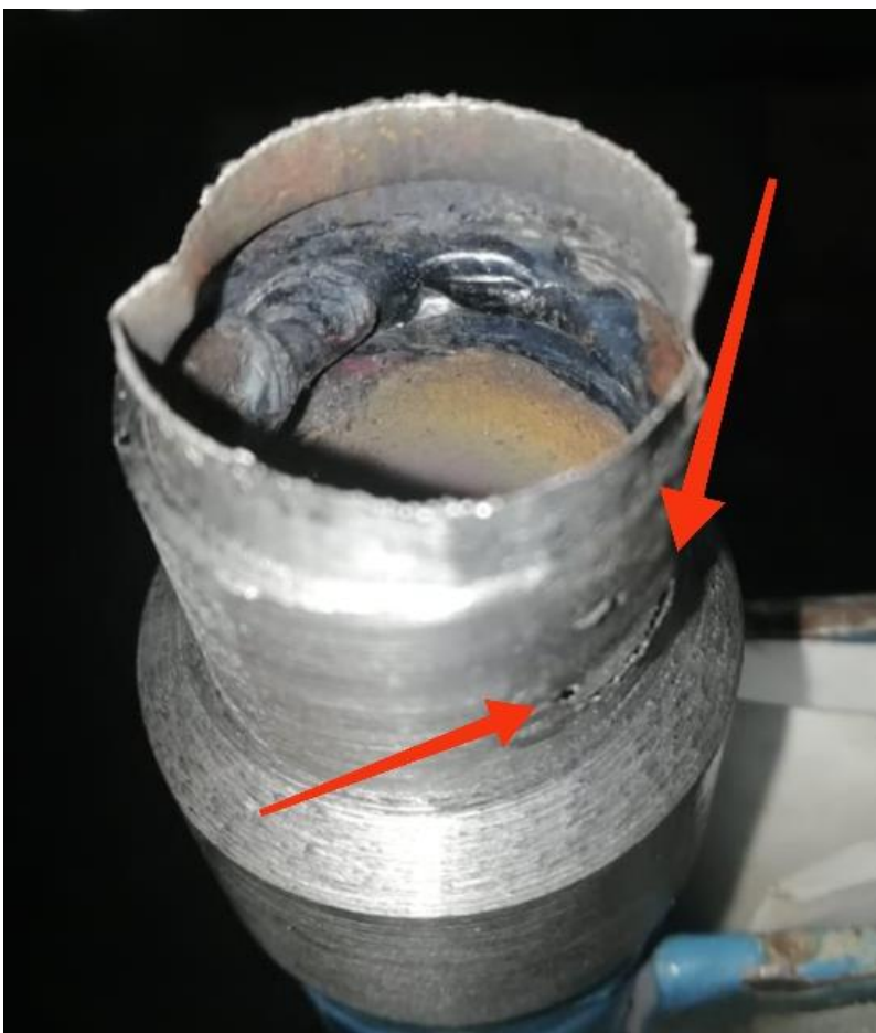
Рисунок 1.7. – Выборка на станке. Совмещенная схема сканирования. Поры в корне шва и продольная утяжина (вогнутость). Объемный и плоскостной дефект
