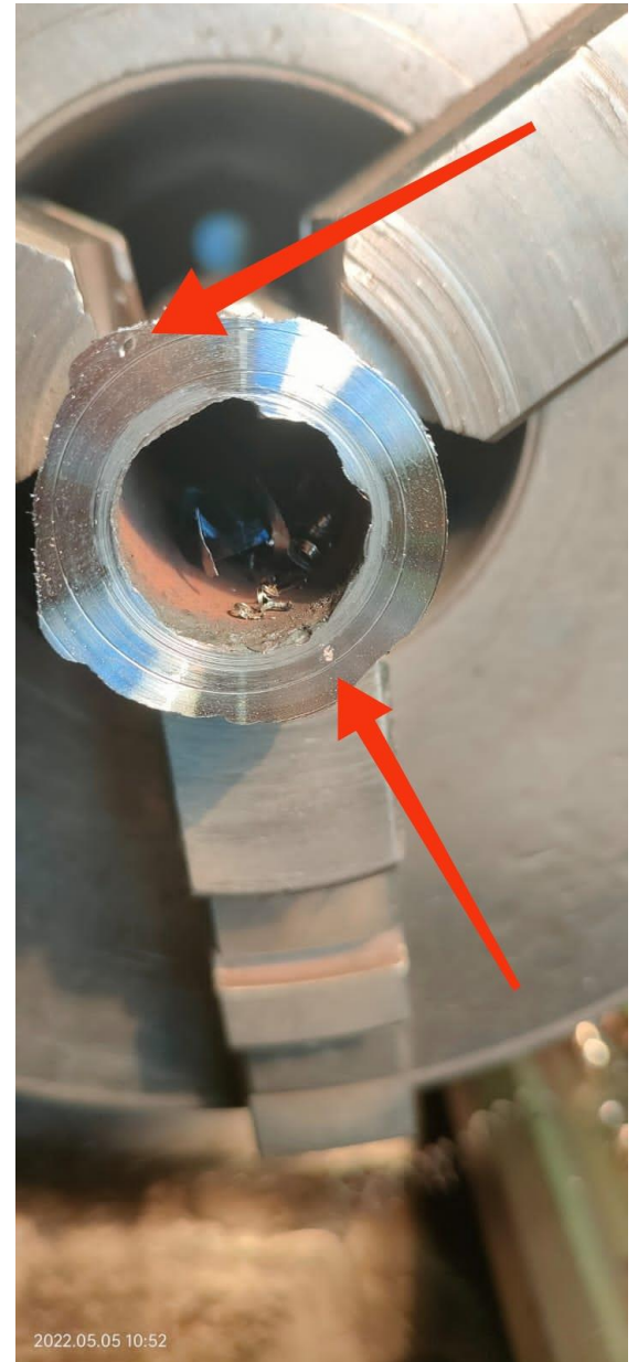
Рисунок 1.8. – Выборка на станке. Хордовая схема сканирования. Поры в сечении и в подповерхностном слое шва. Объемный дефект
