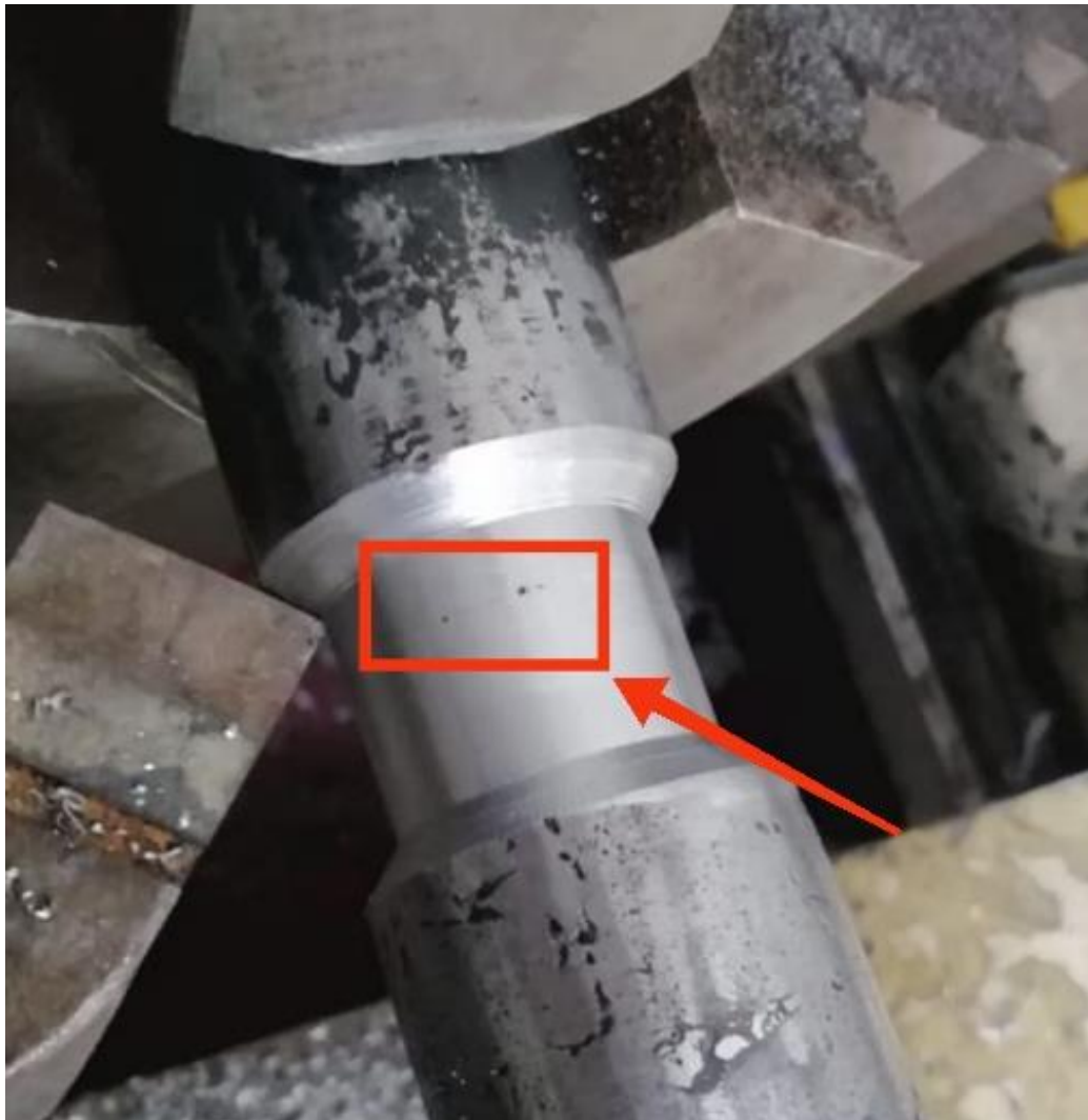
Рисунок 1.4. – Выборка на станке. Хордовая схема сканирования. Надкорневая пора. Объемный дефект
