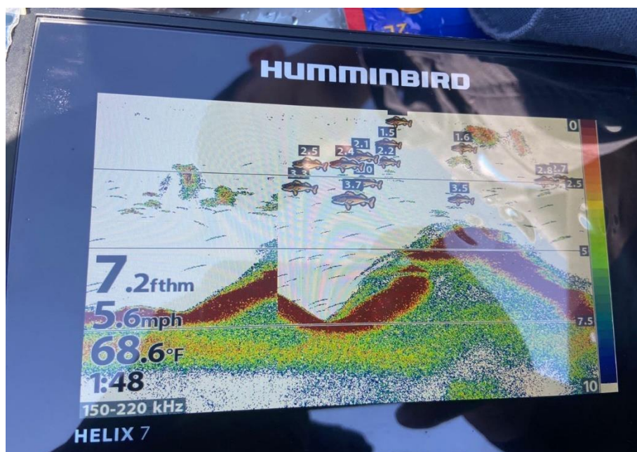
Сурет 2 – Humminbird Helix 7 эхолотының 13,2 м тереңдікті түсіру барысындағы дисплейі. Эхограмма режимі (220 кГц) қосылып тұр.
