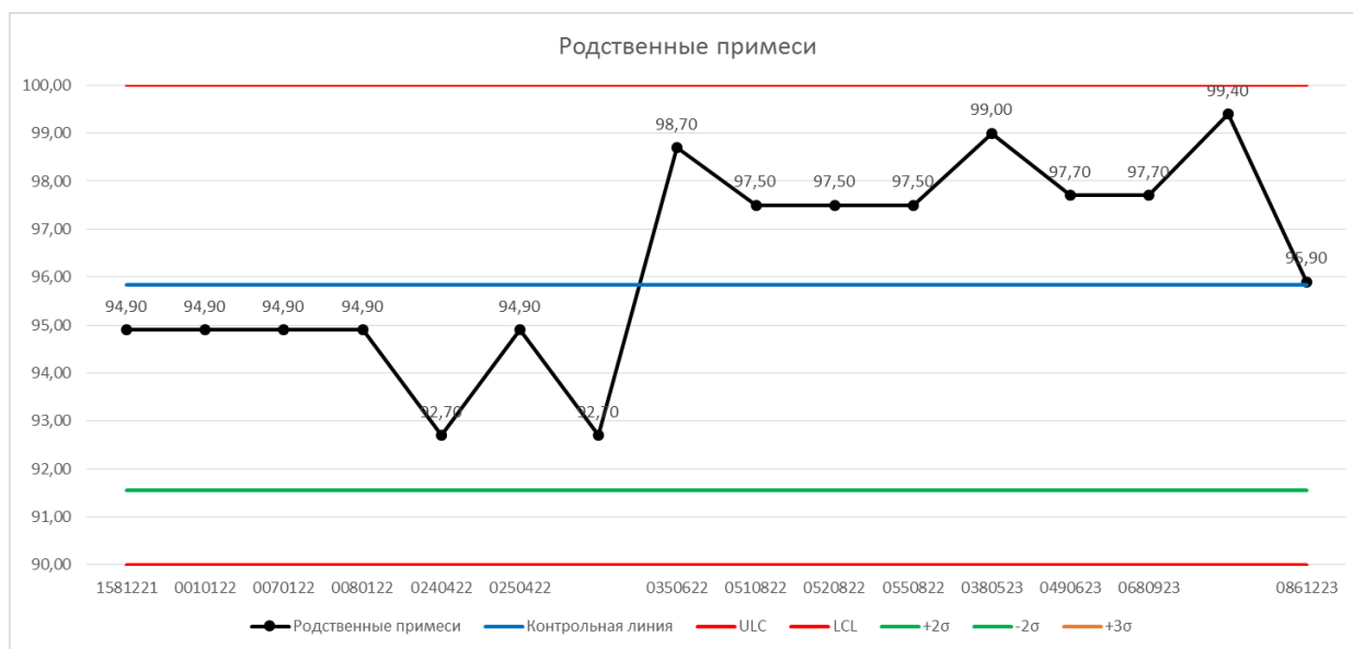
Рисунок 1 – Пример оформления контрольной карты Шухарта для отражения стабильности показателя «Родственные примеси» за период 2021-2023 г.г.
