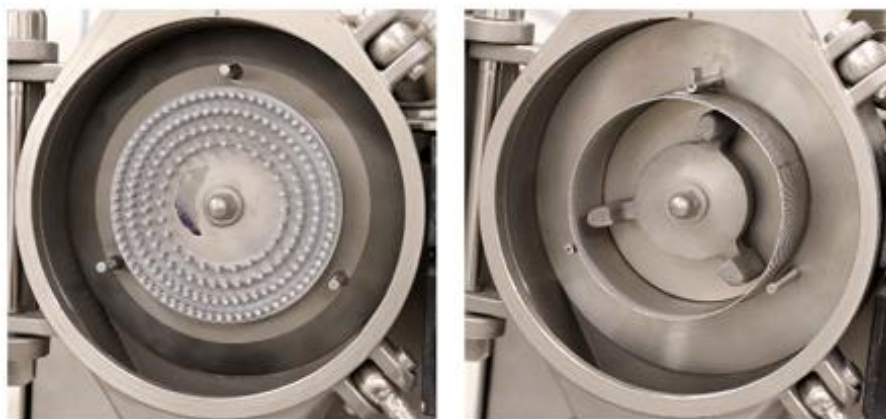
Рисунок 6 - Ротор штифтовой мельницы (вверху слева) и ротор молотковой мельницы (вверху справа) [17]
