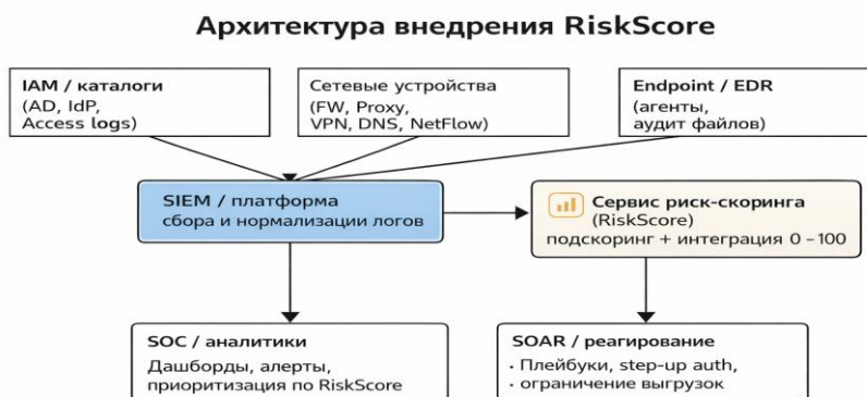
Рисунок 3 – Архитектура внедрения RiskScore в инфраструктуру SOC
